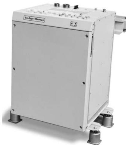
**Рис. П1.5.** 8-слотовый ВК «Эльбрус-90микро» для перебазируемых систем
